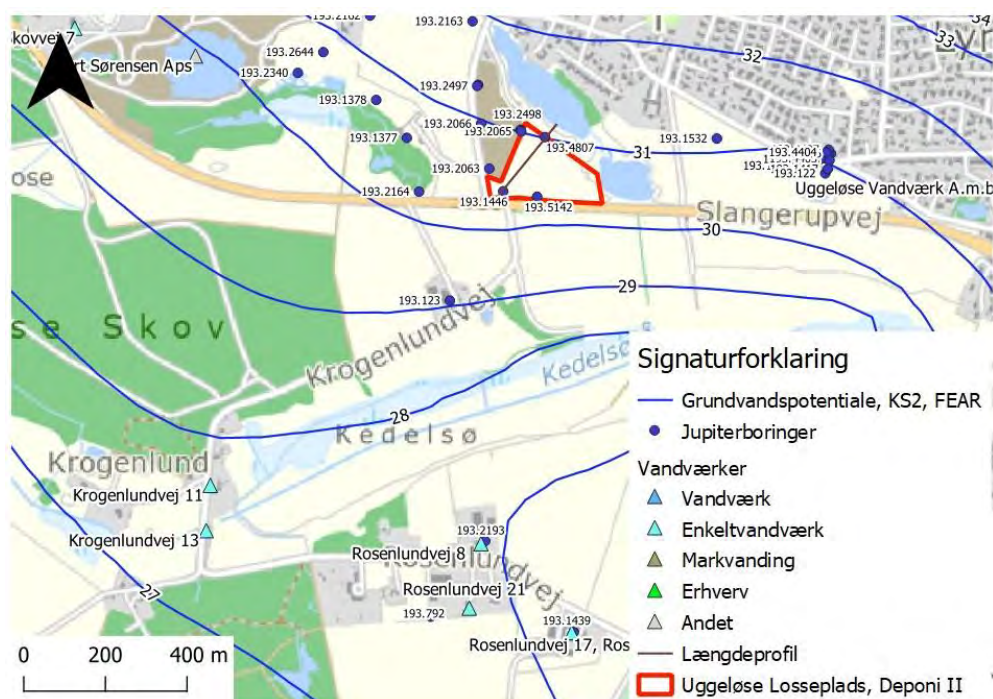
Simuleret grundvandsstand lokalt i sandmagasinet (KS2) jf. FEAR- modellen - vist med mørkeblåkurver (Rambøll April 2019. Grundvandskortlægning i Frederikssund, Egedal, Allerød og Roskilde Kommuner – "FEAR-OMRÅDET". Hydrologisk model. Miljøstyrelsen)
